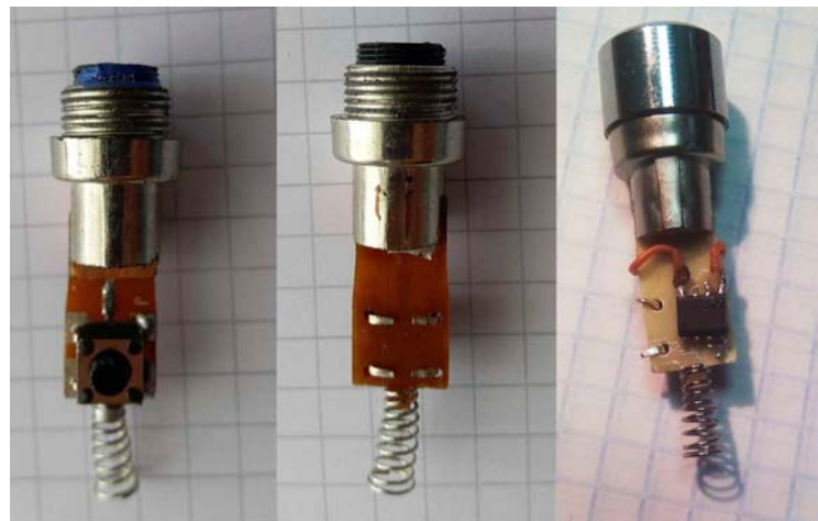
Фото 2. Вид с припаянным контроллером
